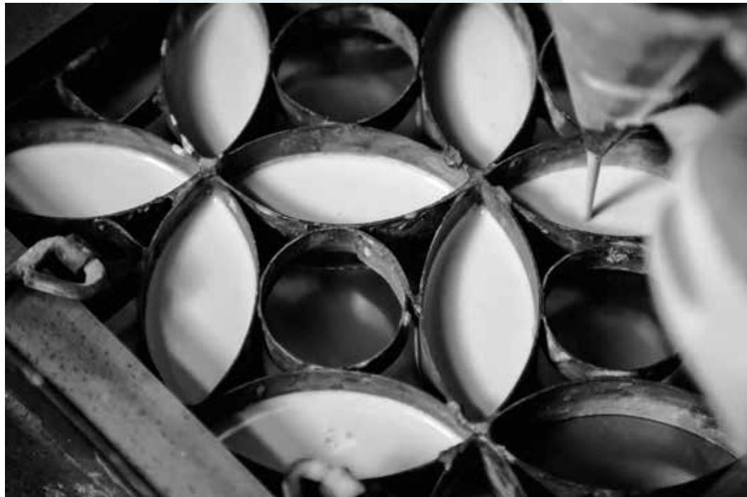
Fabriqués à la main suivant un procédé traditionnel vieux de plus d'un siècle, les carreaux de ciment sont préparés à base de poudre de marbre, de ciment et de colorants et coulés dans des moules en laiton à l'ancienne.
